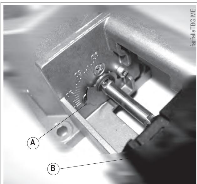
A Índice de referencia de posición de la válvula del gas de mariposa.
