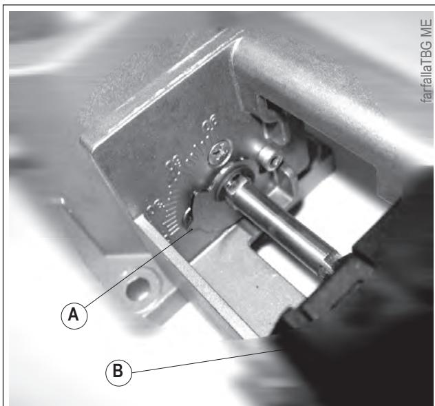
А - контрольный показатель положения газового дроссельного клапана.
