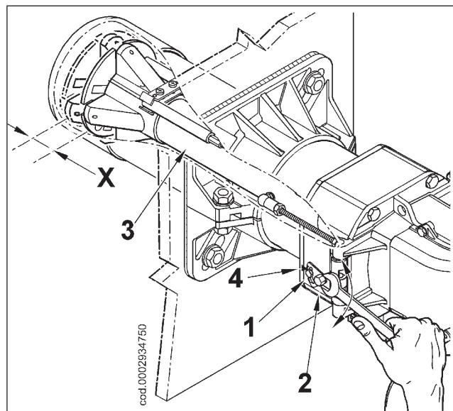
X= Distance tête-disque ; régler la distance X en suivant les indications ci-après :
