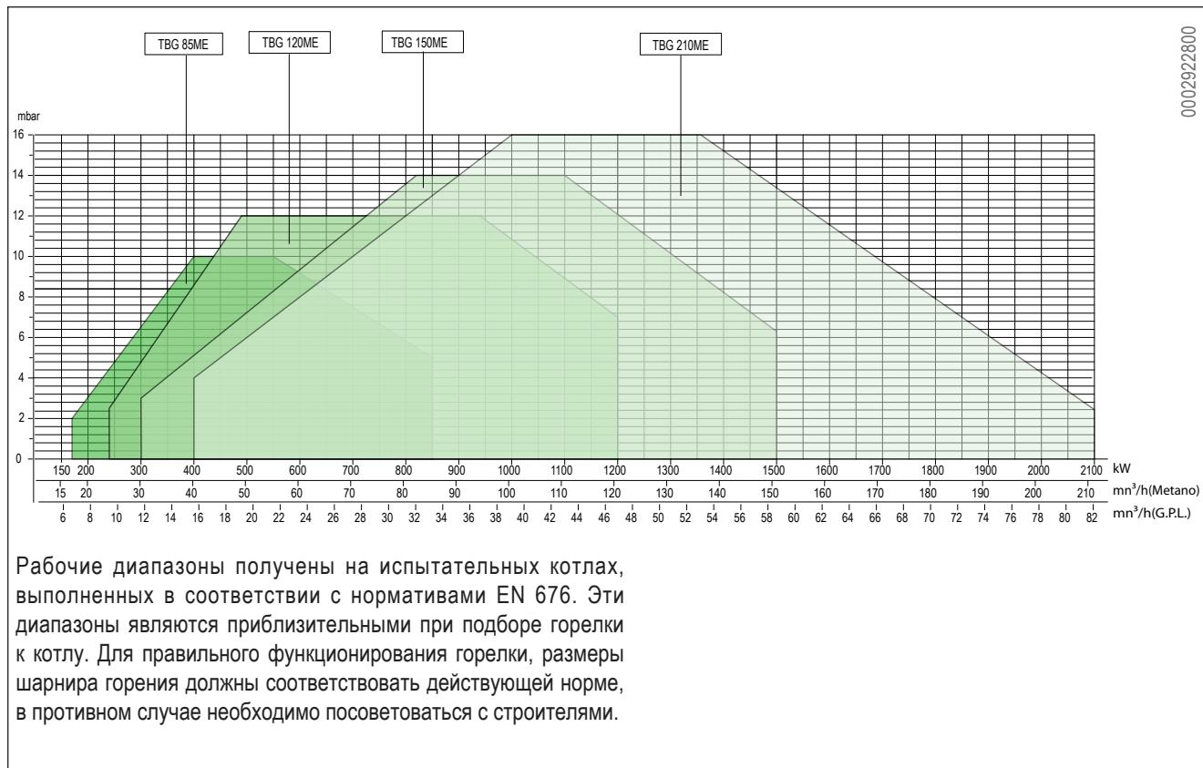
Рабочие диапазоны получены на испытательных котлах, выполненных в соответствии с нормативами EN 676. Эти диапазоны являются приблизительными при подборе горелки к котлу. Для правильного функционирования горелки, размеры шарнира горения должны соответствовать действующей норме, в противном случае необходимо посоветоваться с строителями.
