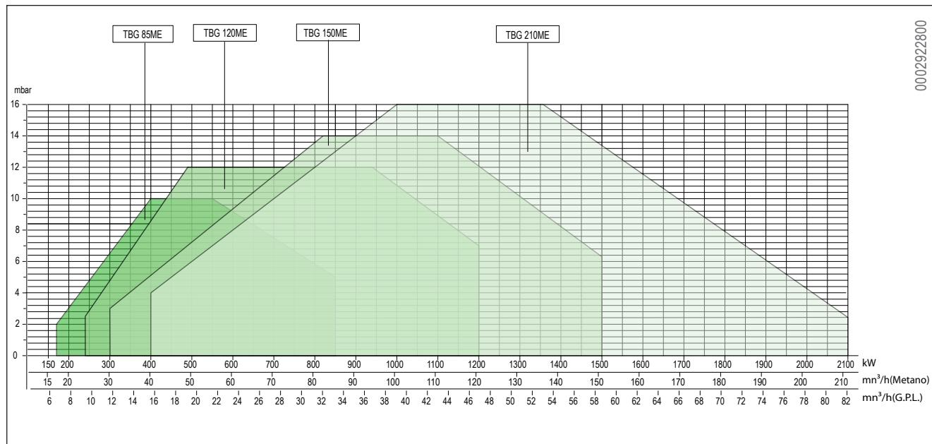
Les champs de fonctionnement sont obtenus sur des chaudières d'essai conformes à la norme EN676 et ils servent d'orientation pour les accouplements brûleur-chaudière. Pour le fonctionnement correct du brûleur, les dimensions de la chambre de combustion doivent être conformes aux normes en vigueur ; dans le cas contraire, consulter les constructeurs.
