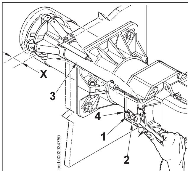
X = Расстояние от головки до диска; отрегулируйте расстояние X, следуя указаниям ниже:
